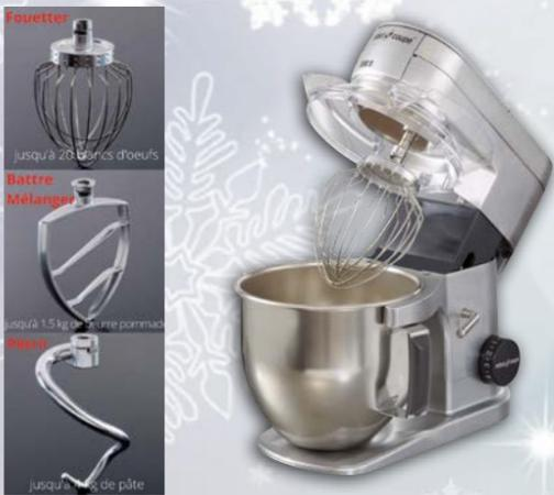
Livré avec 3 outils tout inox : fouet, palette et spirale. Sélecteur de vitesse variable avec 10 vitesses indexées de 60 à 600 tr/mn. Ecran de protection transparent avec grandes ouvertures pour introduction des produits. Basculement de la tête permettant un dégagement total des outils. Bâti tout métallique pour une parfaite stabilité et un entretien facile. Cuve inox avec poignée facile à manipuler, grande capacité de 7,6 litres, mise en place facile. Poids 21,7 kg.
